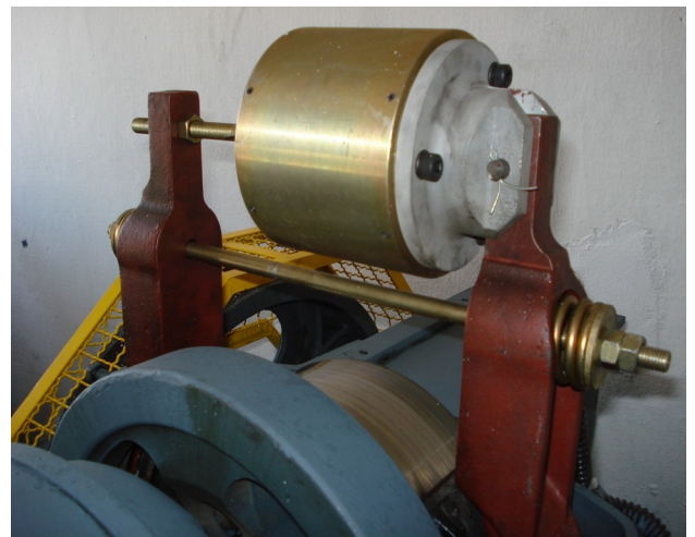
Freio tipo Binder, trabalha com tensão contínua
